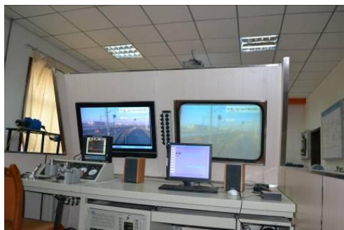
轨道车模拟驾驶系统仿真平台
